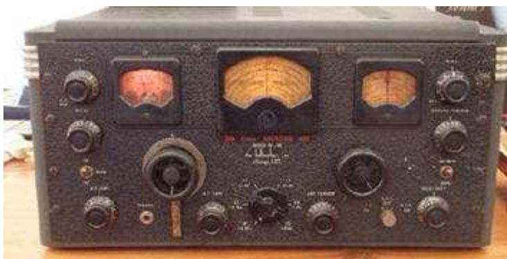
**-SX 28** Super Skyrider Hallicrafter, mastodontico e pesante, singola conversione, 15 valvole, 6 bande da 550KHz a 43MHz, push pull in bassa frequenza, filtro a quarzo, un vero e proprio "Boat Anchor" così li chiamano negli USA causa eccessivo peso.
