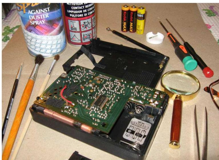
Una bella pulita dalla polvere con pennello e aria e poi una passatina di straccio umettato con liquido "Quasar" ottimo per pulizia di vetri e superfici plastiche: il cofano della radiolina e la trasparenza della scala
