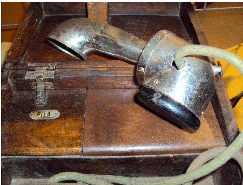
In primo piano la cornetta metallica con microfono e auricolare con tromboncino metallico
