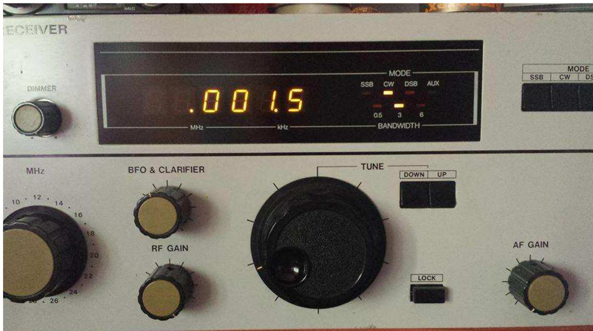
Non ho ancora potuto fare prove certe al di sotto dei 10 kHz non avendo frequenze campioni o un generatore di segnale ma, si riceve benissimo il DCF 77 a 77.5 KHz e le Alfa Russe a 11 e 14 KHz.
