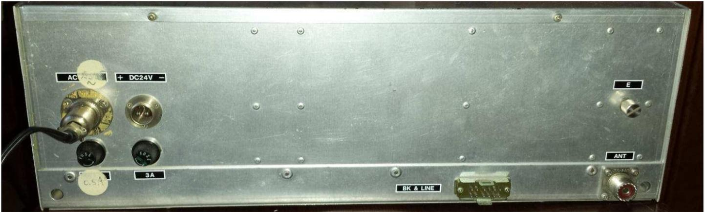
2 prese di alimentazione AC/DC con relativi fusibili, presa accessori, morsetto di terra, e connettore SO 239. Qui mi sono permesso di fare una modifica vista la mia totale antipatia per i connettori PL, ho infatti rimosso l' SO 239 e sostituito con un N da pannello.
